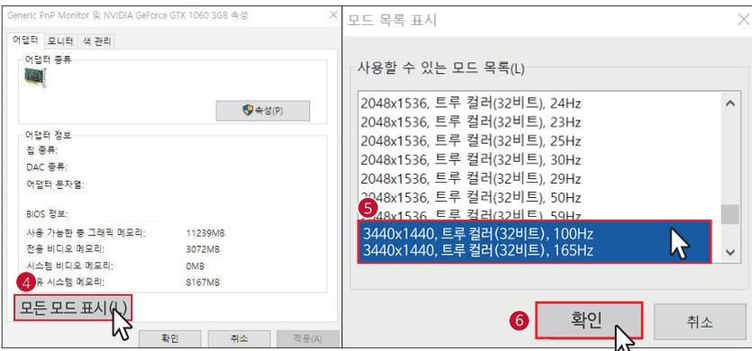
④ [모든 모드 표시] → ⑤ [3440x1440@165Hz] or [3440x1440@100Hz]로 변경 → ⑥ [확인]
